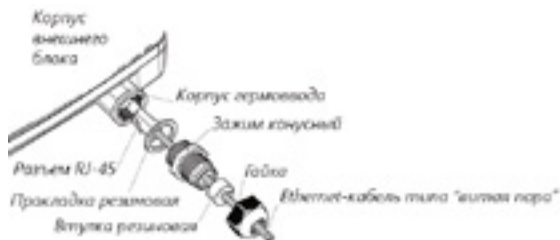
Рис. 1. Подключение Ethernet-кабеля к внешнему блоку
